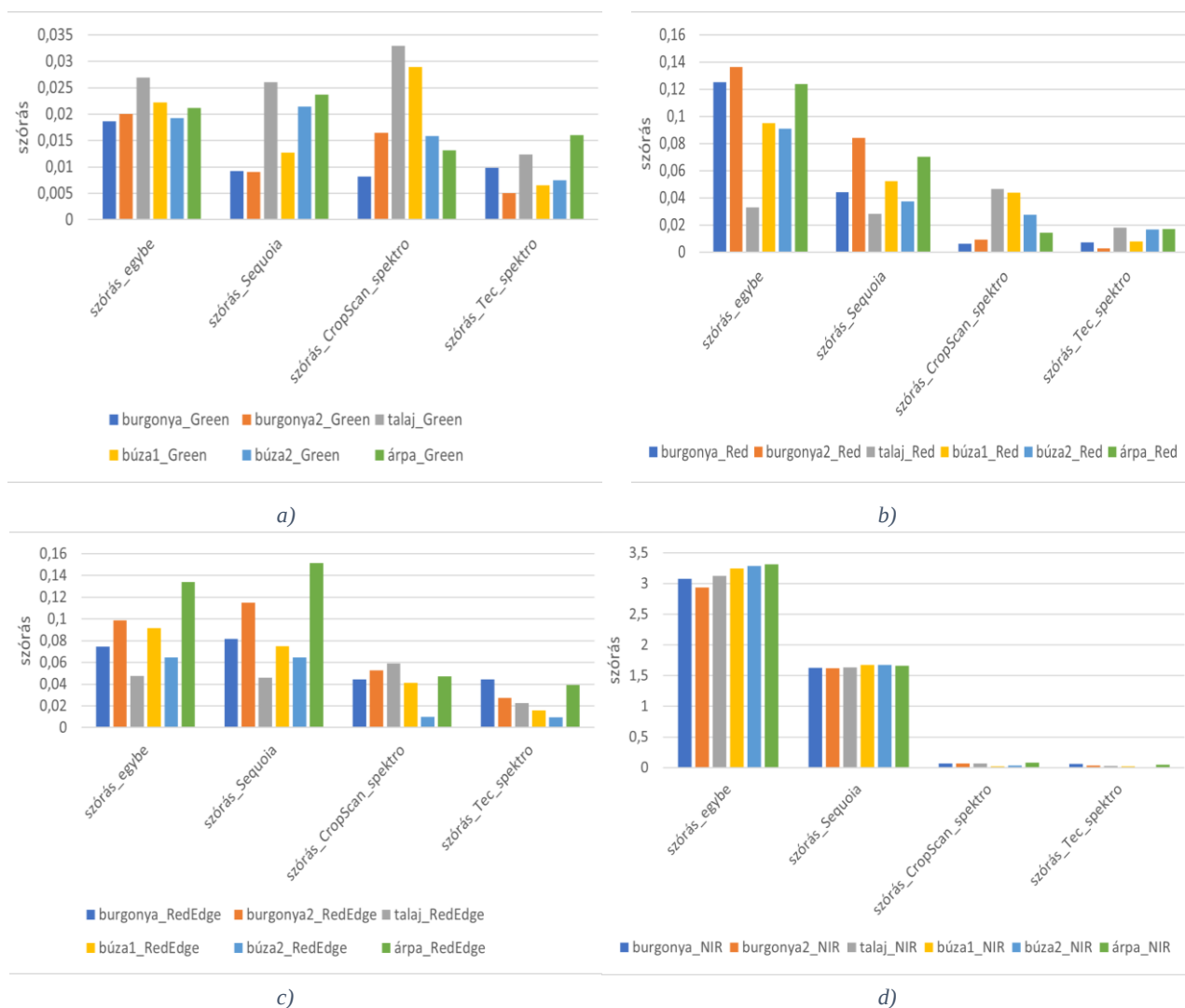
35. ábra – Spektrometriai mérések összevetése a Sequoia multispektrális szenzor több időpontban történő méréseivel, a szórás vizsgálva, csatornák szerinti bontásban: a.) zöld tartomány; b.) vörös tartomány c.) RedEdge tartomány d.) NIR tartomány
