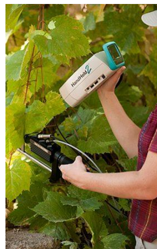
15. ábra – Az összehasonlításhoz használt Plant Probe -bal kiegészített ASD Fieldspec Handheld 2 spektrométer
