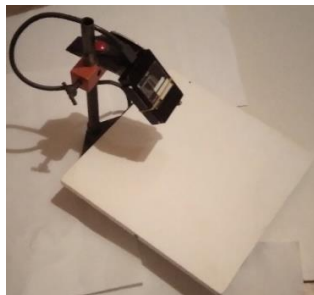
23. ábra - Asztali állvány képe, mely forgatható, a rögzítés 45 fokban tartja a spektrométert, a tartórúd több méretben cserélhető
