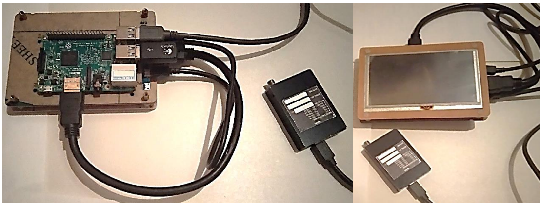
25. ábra - Raspberry Pi-hez csatlakoztatott Qmini spektrométer, internet eléréssel, egérrel és TFT kijelzővel bővítve
