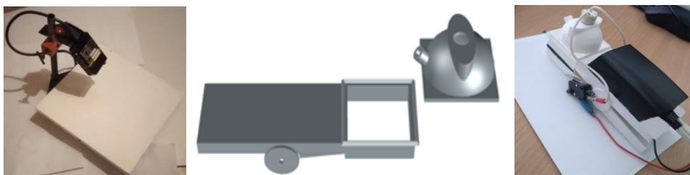
1. ábra – Tervezett prototípusok képe, balra a mérőállvány, középen a mérőfej továbbfejlesztett modellképe, jobbra az elkészült verzió
