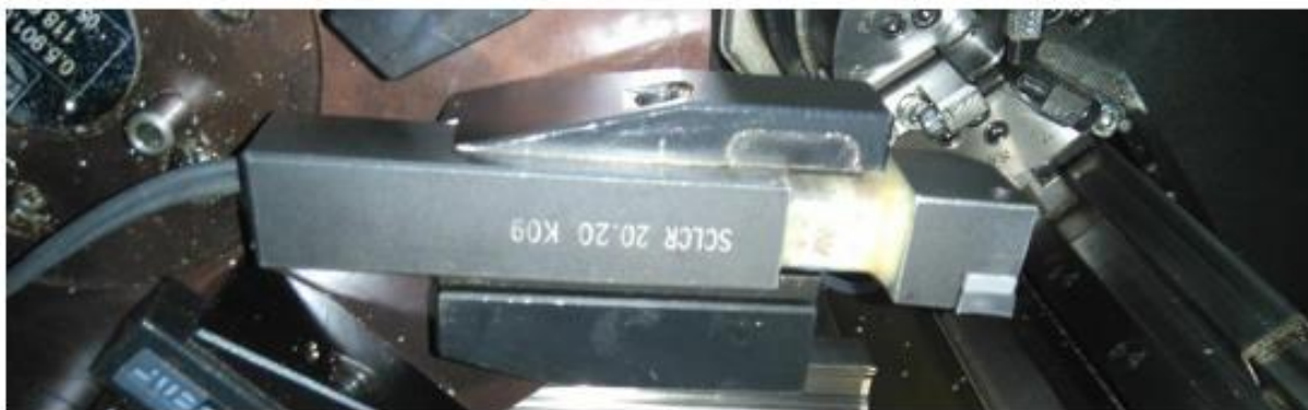
2.11. ábra A nyúlásmérő bélyegekkel ellátott kés a késtartóban elhelyezve (forrás: Dr. Keresztes Róbert)
