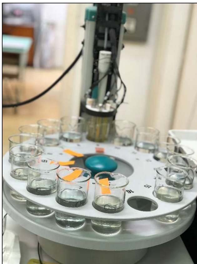
15. ábra Alpha Astree Elektronikus nyelv
