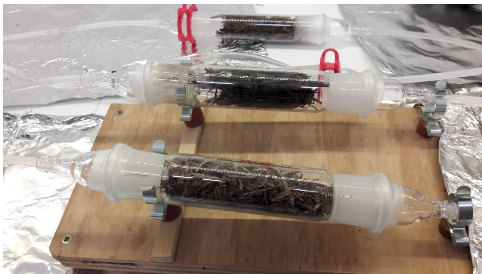
23. ábra: Az illatanyag gyűjtésre használt üveghengerek komposztmintákkal (Fotó: Kecskeméti, 2019)
