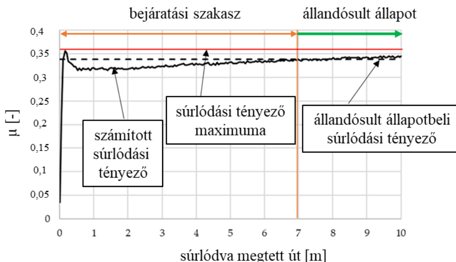
4.32. ábra: Példa a súrlódási együttható grafikonjára
