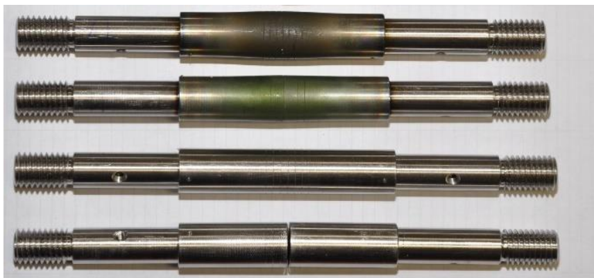
3. ábra A Gleeble mintadarabok RG3 (referencia), DG3 (hegesztés) azonos hőmérséklet és nyomással elvégzett kísérletek után, alatta a kiindulási minták
