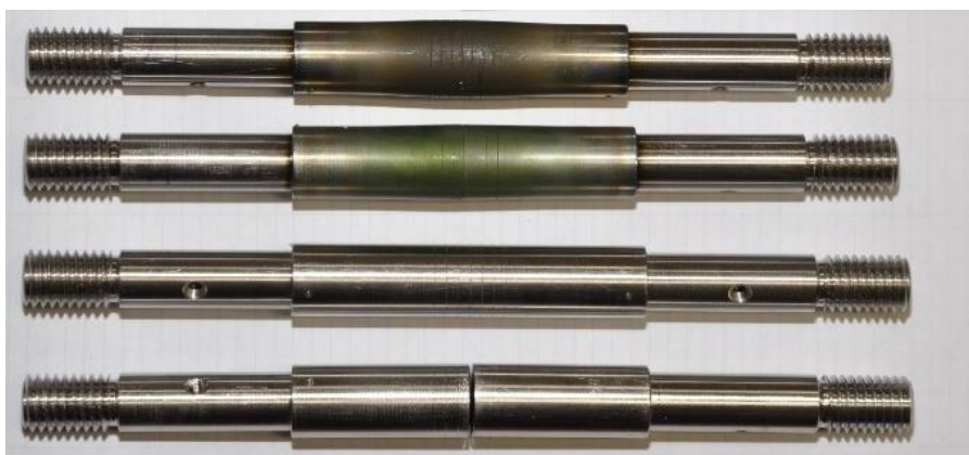
4.5. ábra A Gleeble mintadarabok fentről lefele: RG3 (referencia vizsgálat), DG3 (hegesztési vizsgálat) azonos hőkezeléssel, alatta illusztrációnak a nyers kiindulási minták
